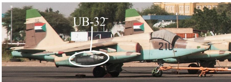
Imagen 11 Su-25 (con el número táctico 210) el 28 de octubre de 2014, equipado con un lanzacohetes UB-32
