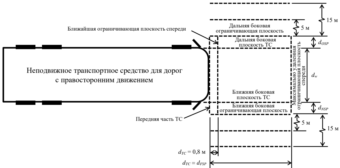
Рис. 1 Схема статических испытаний с пересечением
