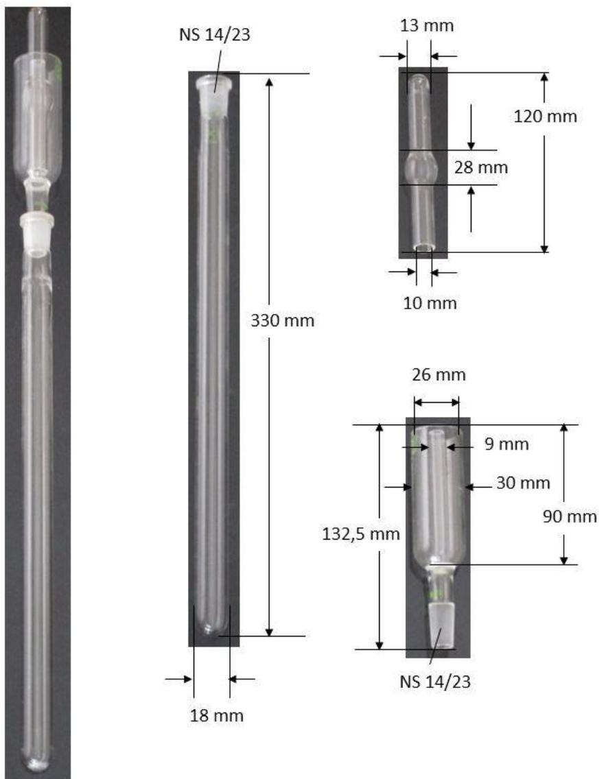
Figura A10.2: Cámara de condensación del ejemplo 2 de la prueba de Bergmann-Junk
