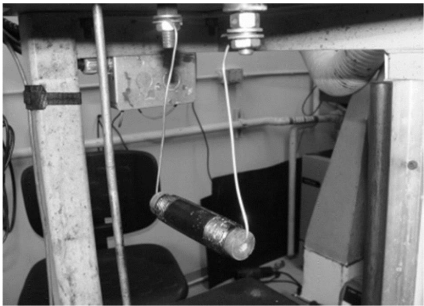
Рис. 18.8.2 Испытательная камера, установленная горизонтально под крышкой сосуда (медные провода подсоединены к стационарным электродам сосуда)
