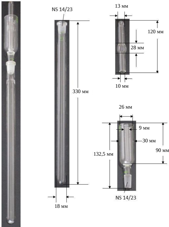
Рис. А10.1: Конденсационная камера для испытания по методу Бергмана-Юнка (пример 1)
