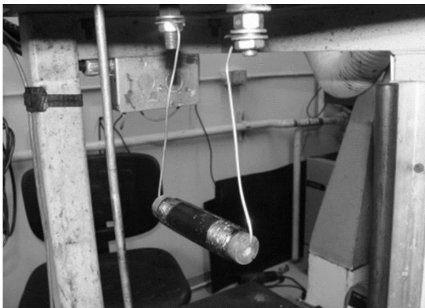
Figure 18.8.2 Chambre d'épreuve montée horizontalement sous le capot de la bombe (conducteurs en cuivre reliés aux électrodes fixes de la bombe)
